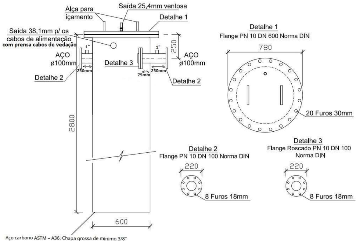
Figura 2.1: Desenho técnico da tubulação.
