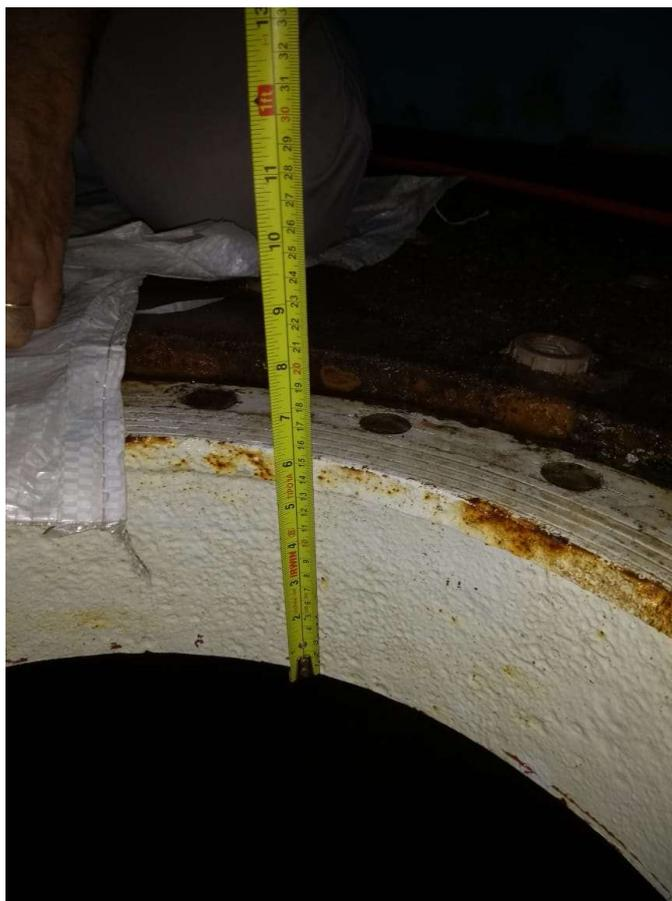
Imagem 2: Fotografia de peça semelhante de Flange com colarinho (item 2)
