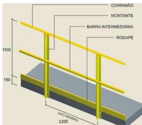
Figura 02: Modelo de guarda-corpo padrão NR12.
