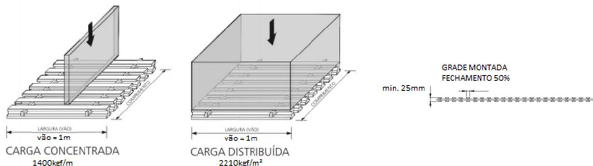
Figura 01: Capacidade mínima de carga de resistência das grades montadas e fechamento.
