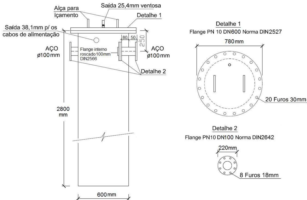
Figura 2 – Poço Falso Modelo 2
