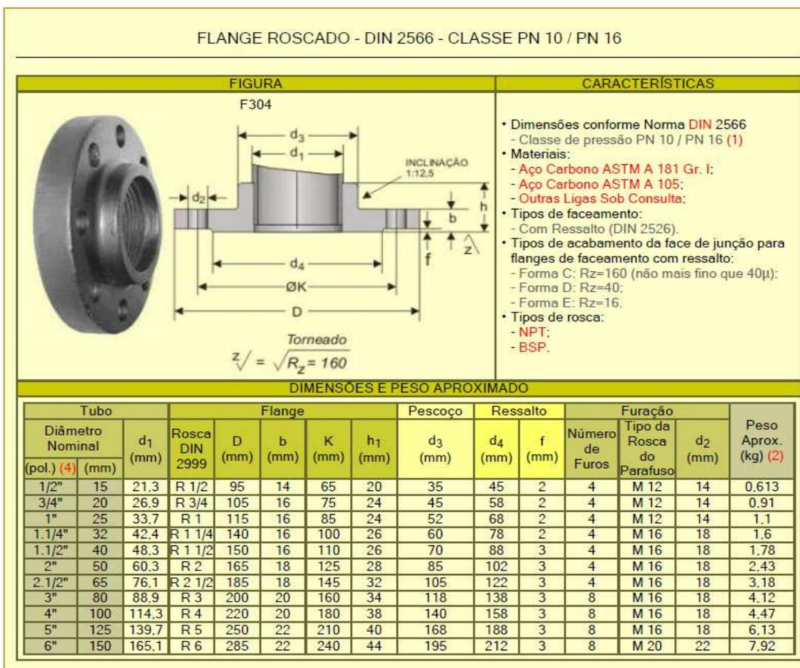
As espessuras dos flanges devem estar de acordo com a Norma DIN. Para flanges roscados, respeitar DIN 2566 e para os soldados DIN 2576:
