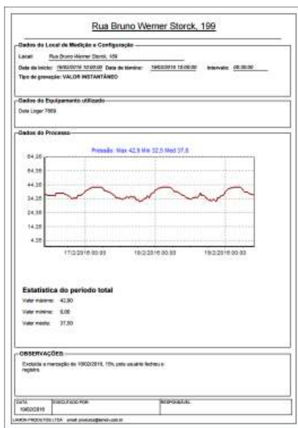
Figura 4 – Medição de pressão da adutora na Rua Bruno Werner Storck
