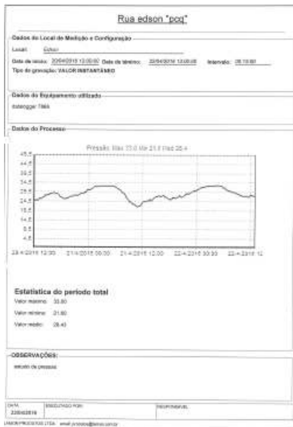
Figura 5 – Relatório de medição de pressão da adutora na Rua Edison
